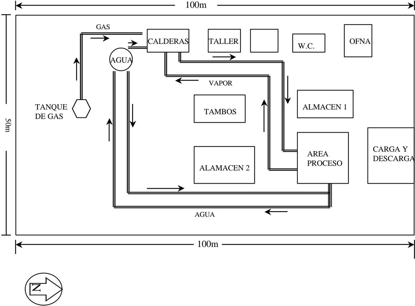
Fig.11 Distribución de agua, gas y vapor en la planta recicladora
